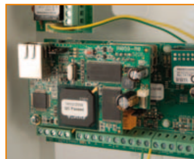
Particolare della centrale SmartLiving10100 con la scheda SmartLAN/G.
